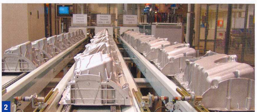
1) Mittels hydraulischer Spannung werden die Wannn bei der Dichtigkeitsprüfung fixiert. Bilder: Frick
