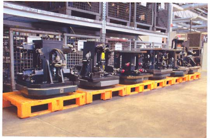
▲ In Wartestellung: AUMA-Vorrichtungen auf Grundplatten eines AMF-Nullpunktspannsystems
