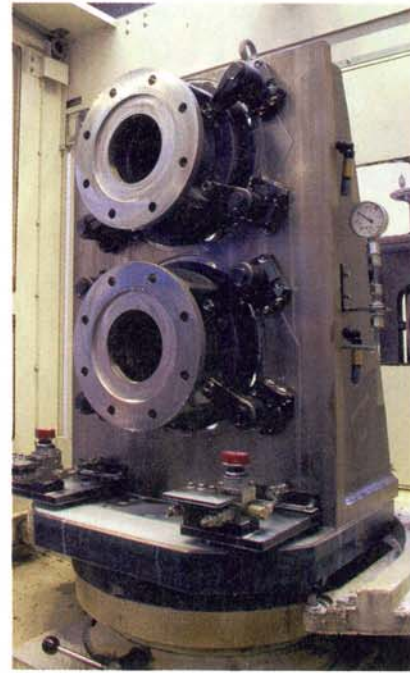
Das AMF-Nullpunkt-Spannsystem sorgt für eine einheitliche Schnittstelle auf allen Maschinen.
