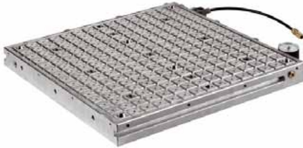
Bild Nr. 03-01 AM_VakuumSpann1.jpg Die neue Vakuum-Spanntechnik von AMF ermöglicht eine verzug- und schwingungsfreie Fünf-Seiten-Bearbeitung von vorwiegend dünnwandigen, nichtmagnetischen Teilen bei nur einer Aufspannung.
