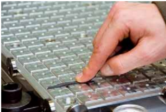
Bild Nr. 03-03 AM_VakuumDetail1.jpg Mit einer Feldereinteilung im 25 mm-Raster sowie Nutenzügen, die abgedichtet werden, ermöglicht das neue Vakuum-Spannsystem von AMF die flexible Positionierung von Werkstücken.
