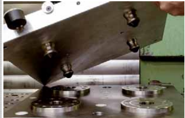
Bild Nr. 03-04 AM_VakuumDetail2.jpg Das neue Vakuum-Spannsystem lässt sich zusammen mit dem Nullpunktspannsystem Zero-Point von AMF für noch rationelleres Wechseln der Platte kombinieren.
