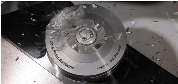
Bild Nr. 14-03 AM_TurbineLive.jpg Das AMF-Spannmodul Turbine sorgt für zuverlässiges Spannen von Werkstücken oder Vorrichtungen auch im automatisierten, mannslosen Betrieb.
