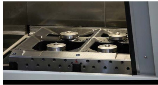
Bild Nr. 14-04 AM_TurbineMTisch.jpg Das AMF-Spannmodul Turbine ist als vollautomatische Aufspannlösung zum Einbau in den Maschinentisch konzipiert und rundet das Sortiment des Herstellers an Nullpunkt-Spannsystemen nach oben ab.
