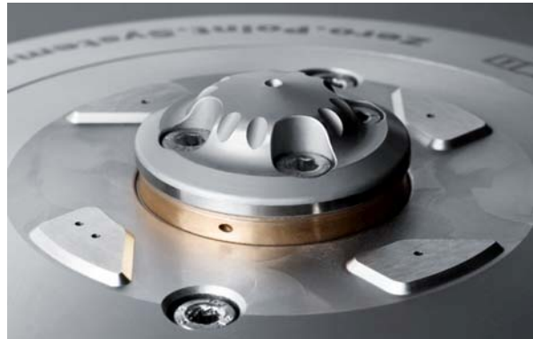
Bild Nr. 14-02 AM_Messingring.jpg Sobald der Luftdruck einsetzt, dreht sich der verschleißfreie Messingring und bläst alle Späne weg.
