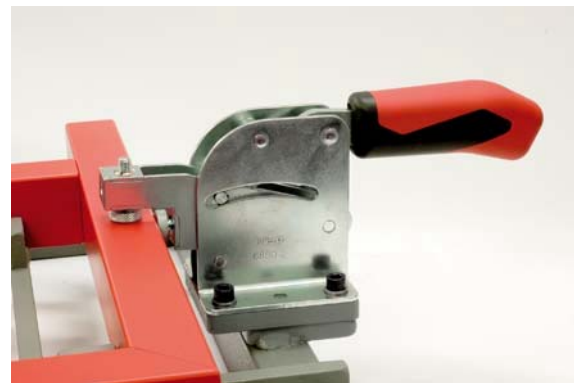
Bild Nr. 05-02 AM_KombiSpnrAnw.jpg AMF-Kombispanner: Die Bewegung des Handgriffes wird über eine Kulissenführung zunächst in eine waagrechte Positionierbewegung und danach in eine senkrechte Spannbewegung übertragen.
