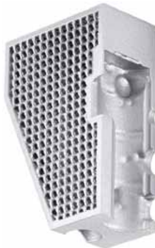
Bild 7: Technologievorteil durch Additive Manufacturing: Die eGRIP Metallfinger von Schunk verfügen über eine integrierte Hohl- beziehungsweise Gitterstruktur, die Gewichteinsparungen zwischen zehn und 50 Prozent ermöglicht
