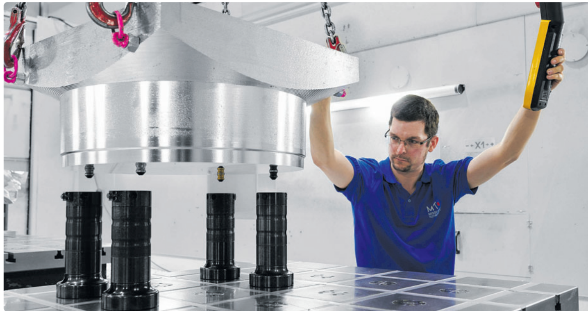
Rüstzeiten mit AMF-Nullpunktspanntechnik minimieren: Mit wenigen Handgriffen ist das Werkstück bei MT Technologies für die Fünfseitenbearbeitung gespannt
