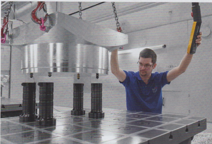
Bild 3: Rüstzeiten mit AMF Nullpunktspanntechnik minimieren: Mit wenigen Handgriffen ist das Werkstück bei MT-Technologies für die Fünfseitenbearbeitung gespannt
