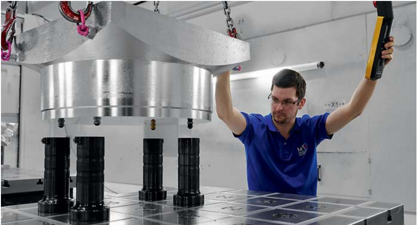
Mit wenigen Handgriffen ist das Werkstück für die Fünfseiten-Bearbeitung gespannt. Bilder: AMF
