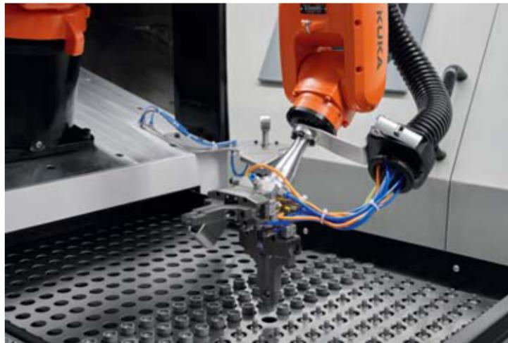
Die smarte und schlanke Beladezelle von AMF mit sehr wenig Platzbedarf wird an Maschinen beigestellt und schafft mehr Produktivität bis hin zu einer mannlosen Schicht.
