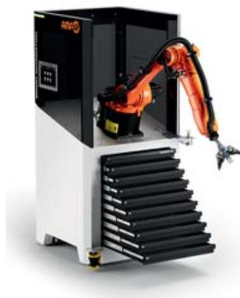
ter mit einer Traglast von 10 kg nicht seitlich anbringt, sondern oben montiert. Darunter befindet sich ein Werkstückwagen mit bis zu zehn Schubladen mit Rasterplatten. Darin lassen sich unterschiedliche Teilegeometrien sicher platzieren. Die Schubladen in drei Varianten mit verschiedenen Höhen öffnet und schließt der Roboter selbstständig.
