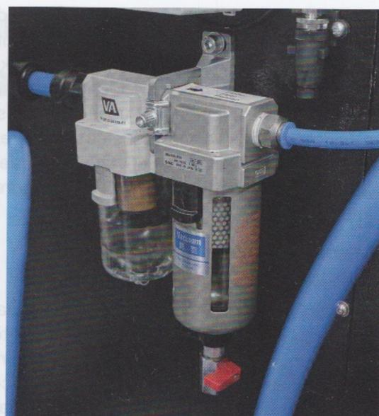
Das Vakuum-Filterssystem mit Flüssigkeitsabscheider und mit einem Druckwächter mit Sensor ist extrem feinfühlig
