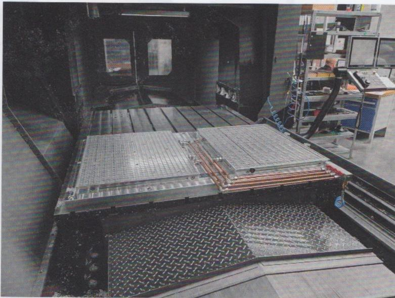
Seit Frühjahr 2023 sind zwei AMF-Vakuumschleifmaschinen Premium Line der Fellbacher Spannexperten in den Abmessungen 600 x 800 mm mit einer Grundplatte verbunden auf dem Maschinentisch befestigt
