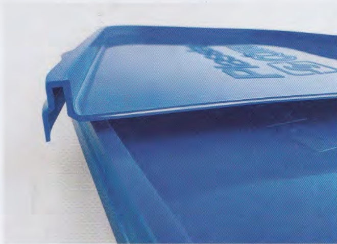
Nahaufnahme des Querschnitts eines Kunststoffdeckels in Sandwich-Technologie mit ca. 30 % weißem Mahlgutanteil (Bild: Contura MTC).
