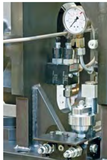
Mit reproduzierbarer und überwachbarer Kraft machen hydraulische Spannelemente Vorgänge prozesssicher und sorgen überhaupt erst für die immer häufiger geforderte Prozessfähigkeit bei der Teilebearbeitung. Bild: AMF
