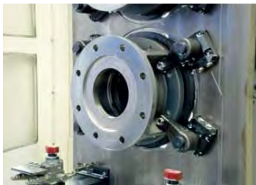
Für Prozessfähigkeit und -sicherheit spannen Hydraulikelemente von AMF immer in der richtigen Reihenfolge, mit der stets gleichen Kraft und an den richtigen Anlagepunkten. Bild: AMF
