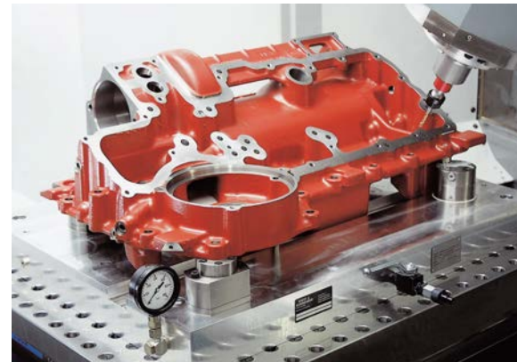
2 Hydraulische Spannelemente von AMF drücken und ziehen mit exakt dosierten und festgelegten Kräften immer gleich und in der richtigen Reihenfolge an definierten Punkten prozesssicher © AMF
