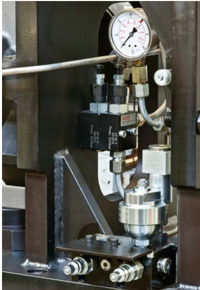
4 Mit reproduzierbarer und überwachbarer Kraft sorgen hydraulische Spannelemente Vorgänge überhaupt erst für die immer häufiger geforderte Prozessfähigkeit bei der Teilebearbeitung © AMF
