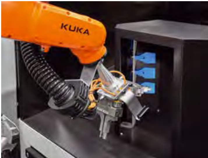
5 Das bearbeitete Teil führt der Roboter in die gegenüber positionierte Smart Cleaning-Einheit. Dort hält er es in den Luftstrahl, der über sechs Düsen Späne und Kühlflüssigkeit wegbläst. © AMF
