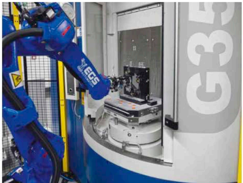
Gehäuse und zwei Deckel aus Aluminiumguss werden bei Scherzinger vollautomatisch und mit AMF-Vorrichtungen mannlos bearbeitet. Der Deckel wird senkrecht in die bogenförmige AMF-Vorrichtung eingebracht, die ihn an den schmalen Seiten komplett umschließt. Bild: AMF
