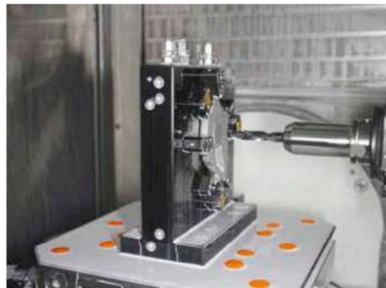
Die Grob 350 kann mit ihrem einzigartigen Maschinenkonzept der horizontalen Spindellage und dem Schwenktisch das Werkstück nach Messung der Lage für jede notwendige Bearbeitung toleranzgenau positionieren. Bild: AMF
